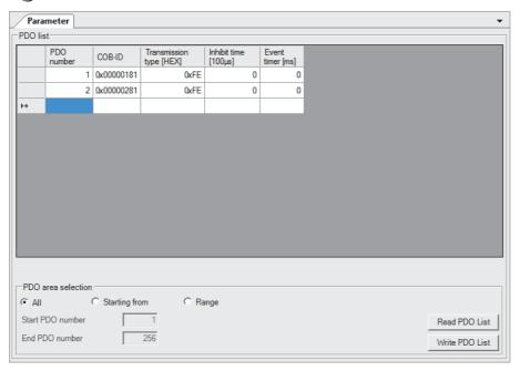
[Navigator] ⇒ [CANopen Configuration] ⇒ Node name ⇒ [Receive PDO]
